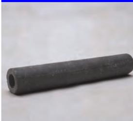
Tubo in fibrocemento per armatura di pareti impermeabili. Serve da distanziatore dal cassero e come guaina per il tirante in ferro. Così viene assicurato lo spessore della parete in calcestruzzo e il recupero dei tiranti. Estremi da rifilare!
